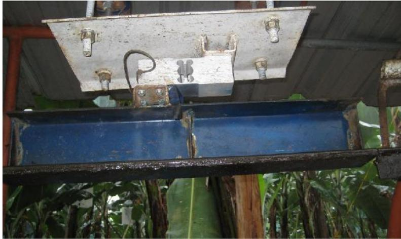
*Balanza electrónica con sistema Tru Test ID 3000 incorporada en el cable-vía en finca de Ecuador*
